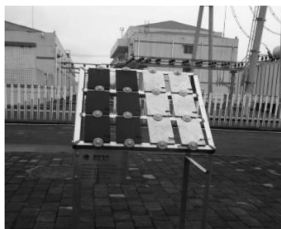
图1 “暴露”法大气金属腐蚀挂片试验现场图
